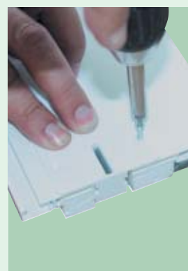
4. Gurtführung einsetzen und verschrauben. Empfohlen: Senkkopf-Schraube 3 x 16
