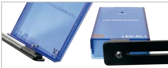
Bild 5: Die Befestigung des Stromversorgungsgerätes an der Blitzschiene
