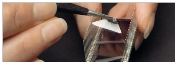
Bild 22: An der Displayunterseite ist die dünne Schutzfolie vorsichtig abzuziehen.
