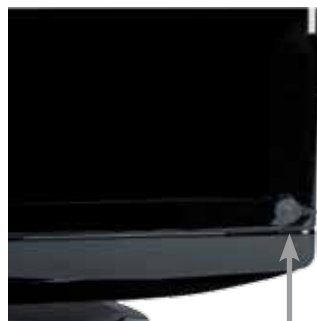
versteckte Installation, Infrarot-sensor an Gerätevorderseite
