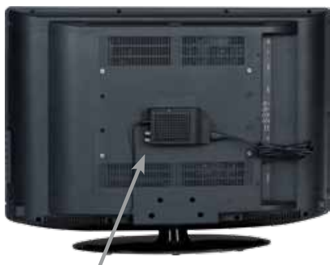
Installationsbeispiel: TELEMINI HD an Gerät-rückseite LCD-Fernsehgerät
