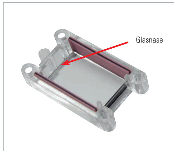
Bild 5: Die in die Displayabdeckung eingelegten Leitgummistreifen und das Display
