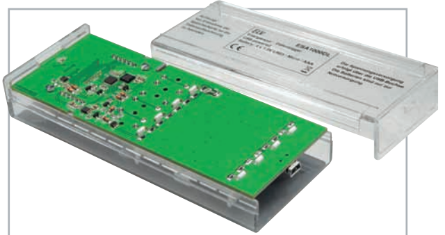
Bild 10: So erfolgt das Einsetzen in das Gehäuse: Platine kopfüber in das Oberteil einlegen, danach Unterteil aufschieben.
