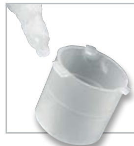
Bild 6: So wird ganz wenig Kleber auf die Haltenasen der Abdeckkappe aufgetragen.
