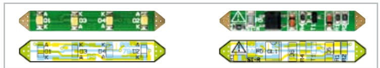
Die Platine der LED-Soffitte mit dazugehörigem Bestückungsplan, oben die Lötseite, unten die Bestückungsseite
