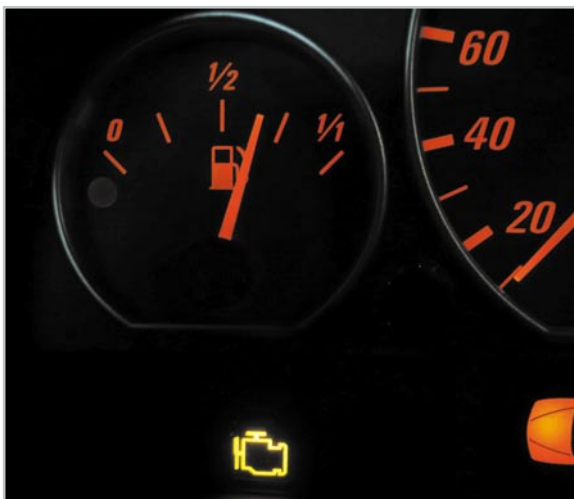
Bild 1: Leuchtet die „Motorkontroll-Lampe“ (MIL) bei laufendem Motor auf, hat das OBD einen Fehler in Abgasanlage bzw. Motormanagement gefunden. Das Aufleuchten nach Einschalten der Zündung ist hingegen normal.
