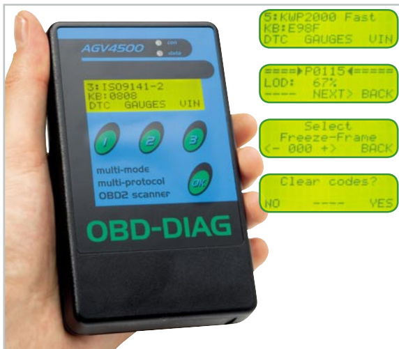
Bild 6: Zusätzlich mit USB-Schnittstelle und Diagnosesoftware – der OBD-DIAG-4500-Handheld-Scanner
