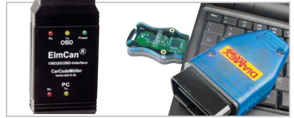
Bild 11: Drahtlose Verbindung zum PC – Bluetooth-Interfaces machen das lästige PC-Kabel überflüssig.
