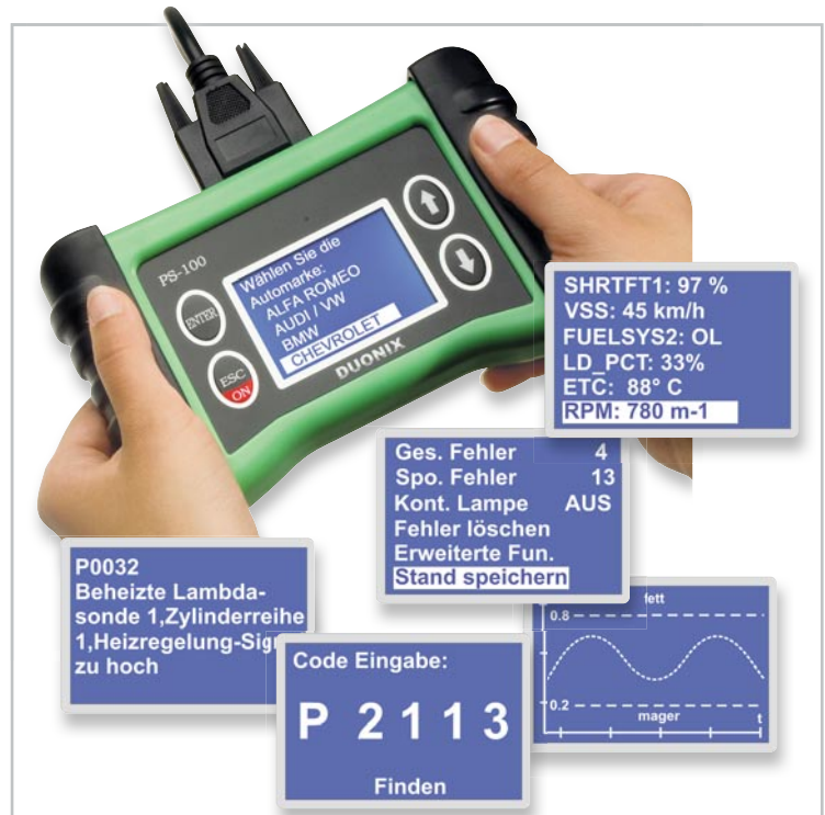
Bild 7: Speichert die erfassten Daten und kann sie später an ein PC-Programm ausgeben – der PS-100 sticht auch durch sehr umfangreiche Funktionen als PC-unabhängiger Scanner hervor, z. B. durch grafische Anzeigen.
