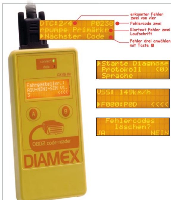
Bild 5: Der Klassiker: DIAMEX DX 45, ein preiswerter OBD-Scanner mit integrierter Klartext-Fehlercode-Datenbank
