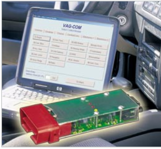
Bild 9: Besonders preiswert: Bausätze für ein bestimmtes Protokoll, hier der ELV-Diagnose-Adapter für VAG-Fahrzeuge
