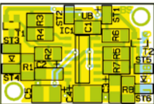
Vergrößerte Ansicht der fertig bestückten Platine des Blaulicht-Simulators mit zugehörigem Bestückungsplan (Originalgröße: 26 x 19 mm)
